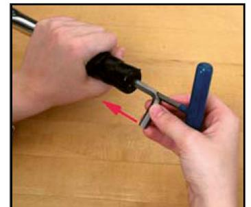
3. Den Werkzeugkopf auf den Schlüssel aufstecken. Dann den Schlüssel auf das Prüfgerät bringen und ein oder zwei Lastwechsel durchführen („abklicken“), dabei jeweils das Messergebnis notieren.
