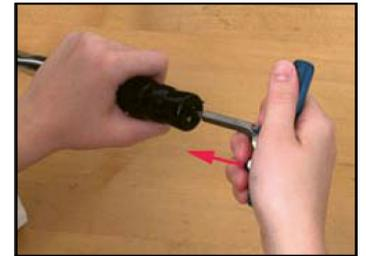
2. Nun den Konterschlüssel hineinschieben bis er in die Kontermutter einrastet. Nötigenfalls den Konterschlüssel leicht drehen, damit er den Innensechskant der Kontermutter erfasst. Dann den Konterschlüssel mehrere Umdrehungen im Gegenuhrzeigersinn drehen, um sicherzustellen, dass die Kontermutter vollständig von der Justierschraube gelöst ist und dass für die Justierschraube genügend Spielraum besteht, um die gewünschte Drehmomenteinstellung zu erreichen.
