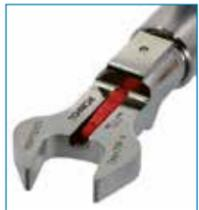
Es werden Einwegmarker verwendet, somit ist das Auffüllen von Tinte nicht notwendig. Ein Marker führt rund 2000 Markierungen aus. Das Austauschen des Markers ist rasch und einfach. Sowohl horizontales als auch vertikales Arbeiten ist möglich.
