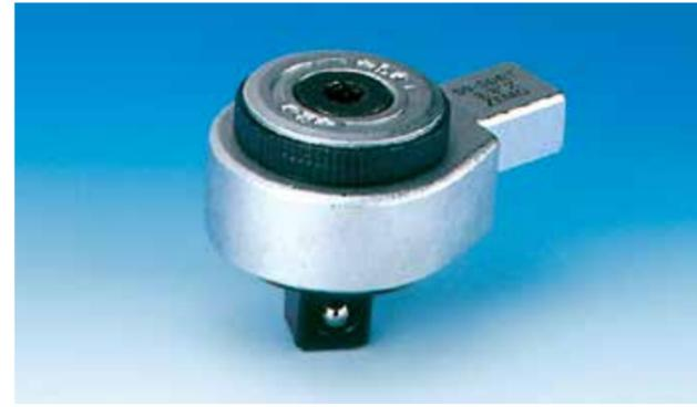
Umsteuerbarer Vierkantratschen-Kopf mit Rechteckaufnahme 9×12 mm bzw. 14×18 mm. Der Aufsatz wird durch einen federnden Haltestift gesichert.
