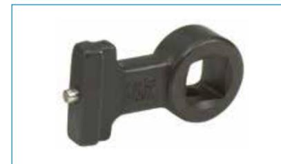
SR-Adapter **'Crowfoot'** zur Verwendung auswechselbarer Dovetail-Aufsätze auf Drehmomentschlüsseln mit Vierkantabtrieb, z.B. 'Flat Beam'. Der Hebelarm muss jedoch zwingend neu ermittelt werden, um das Drehmoment errechnen zu können.
