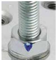
Bei Erreichen des voreingestellten Anzugsmoments hinterlässt dieser Klick-Drehmomentschlüssel als Nachweis des ordnungsgemäßen Festziehens automatisch eine farbige Markierung auf einer Ecke der Mutter bzw. des Schraubenkopfes.
