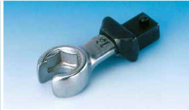
Auswechselbarer Offenringschlüssel-Kopf mit Rechteckaufnahme 9×12 mm. **Sonderanfertigung SFN mit Anschlag (Schulter)** und Mittenabstand 36,5 mm. Der Aufsatz wird durch einen federnden Haltestift gesichert.
