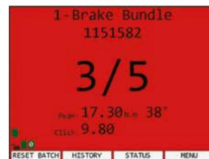
Was aber, wenn der Bediener weiter zieht? Beispiel: Der Drehmomentschlüssel hat bei 9,8 Newtonmetern geklickt. Doch der Bediener zog weiter, bis das finale Drehmoment 17,3 Newtonmeter betrug. Sowohl die TAC- als
