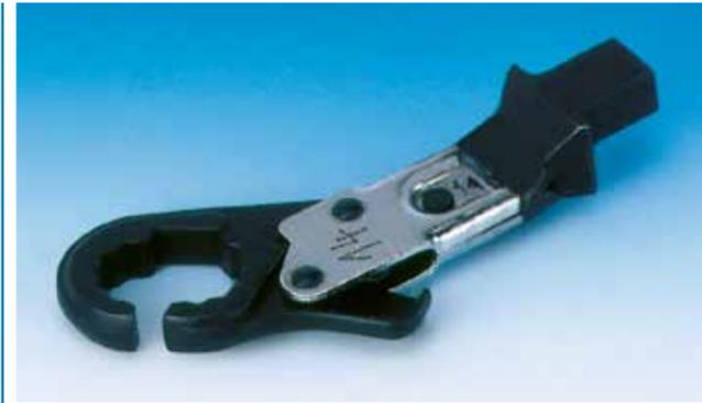
Gekröpfter Ringratschen-Kopf mit Rechteckaufnahme 14×18 mm. Der Aufsatz wird durch einen federnden Haltestift gesichert.
