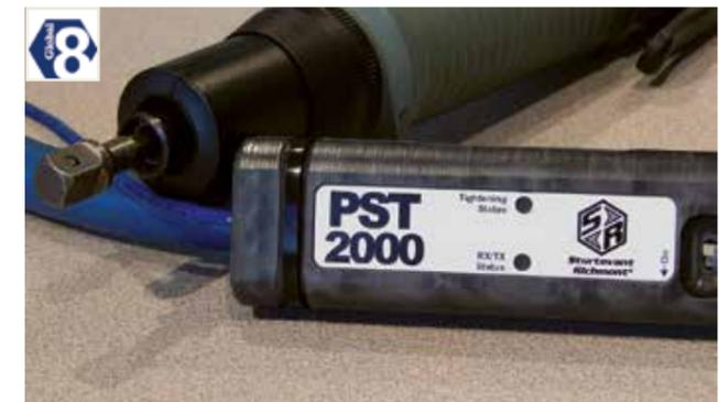
Batteriebetrieben oder mit einem Netzteil, die PST-Monitore messen den Luftdruck an der sensibelsten Stelle eines pneumatischen Werkzeugs – im Motorraum. Warum? Dort ist der Luftdruck direkt mit der Leistung des Impulswerkzeugs verbunden.
