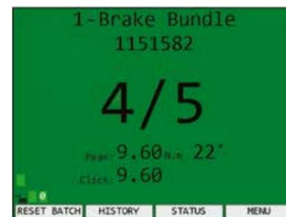
"Klick"-Drehmomentwert, also den Punkt, an dem der Schlüssel auslöst. Außerdem gibt es den Spitzenwert. Dies ist der Punkt, an dem der Bediener aufhört zu ziehen. Das Display des Global 400 zeigt auch, dass der entsprechende Drehmomentwert z.B. 22 Grad nach Erreichen des parametrierten Schwellwertes erreicht wurde.
