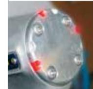
LED Statussignale (grün = iO, rot = NiO), rundum sichtbar – von oben, unten, links, rechts, vorn, hinten.
