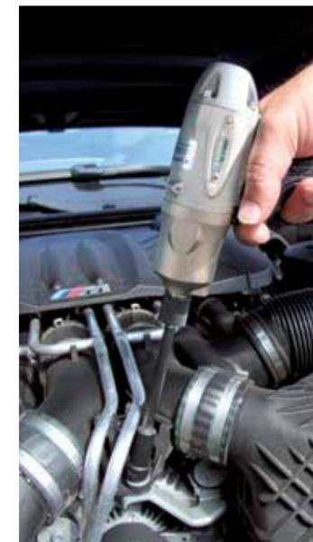
schnell erreicht. Ein harter Schraubvorgang benötigt nur 1-2 Sekunden. Und es gelangen keine Drehmoment-Reaktionen ins Handgelenk des Bedieners.
