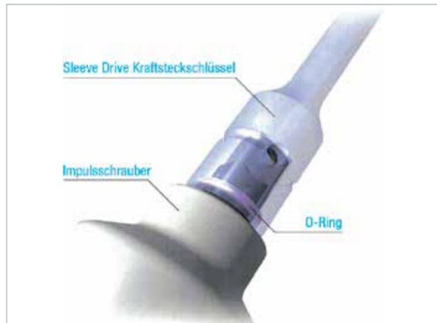
Ein im Antriebsende der spindelgeführten Action® Kraftsteckschlüssel eingesetzter O-Ring optimiert den festen Sitz auf der Schrauberspindel und sorgt somit für die unmittelbare Weitergabe des vorgegebenen Drehmoments ohne nennenswerte Kraftverluste. Zudem wird die Lebensdauer des Steckschlüssels zusätzlich erhöht.
