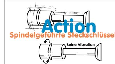
Für Impulsschrauber empfehlen wir Kraftsteckschlüssel und Verlängerungen mit Spindelführung – weniger Spiel, weniger Verschleiß für eine dauerhaft gleichbleibende Kraftabgabe.
