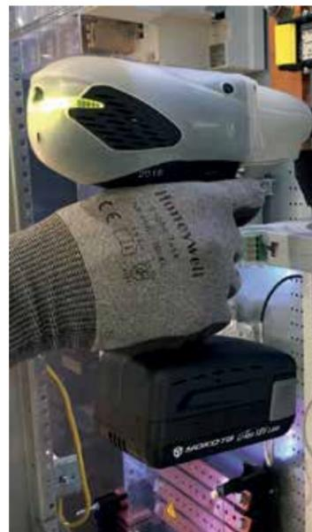
In Yokota's EC-Akku-Impulsschrauber YS-e ist direkt auf der Antriebsspinde ein Drehmoment-sensor und ein **Drehwinkel**-Messwertnehmer integriert. Dieser Schraubertyp ist die perfekte Lösung für Verschraubungen, die genau überprüft, kontrolliert und dokumentiert werden müssen, und wo Steuerkabel und Luftschläuche stören würden.
