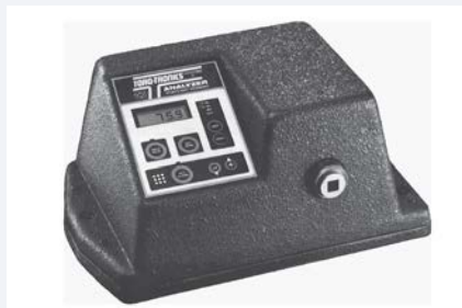
1988 – Digitales Drehmomentprüfgerät (Torq-Tronics)
