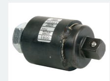
Optional: Schraubensimulatoren (RDF) bis 340 Nm.
