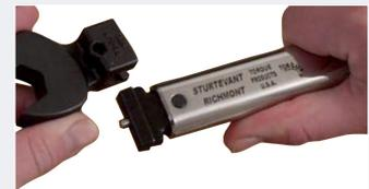
Jeder Dovetail-Aufsatz passt auf jeden Dovetail-Schlüssel.
