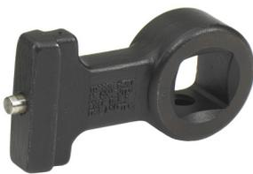
SR-Adapter **'Crowfoot'** zur Verwendung auswechselbarer Dovetail-Aufsätze auf Drehmomentschlüsseln mit Vierkanttrieb, z.B. 'Flat Beam'. Der Hebelarm muss jedoch zwingend neu ermittelt werden, um das Drehmoment errechnen zu können.
