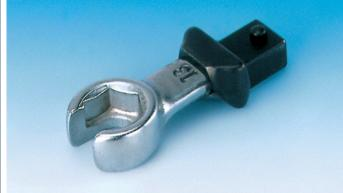
Auswechselbarer Offenringschlüssel-Kopf mit Rechteckaufnahme 9×12 mm. Sonderanfertigung SFN mit Anschlag (Schulter) und Mittenabstand 36,5 mm. Der Aufsatz wird durch einen federnden Haltestift gesichert.
