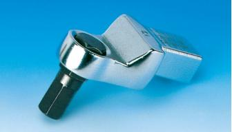
Auswechselbarer Sechskantabtrieb-Kopf mit Rechteckaufnahme 9×12 mm. Der Aufsatz wird durch einen federnden Haltestift gesichert.
