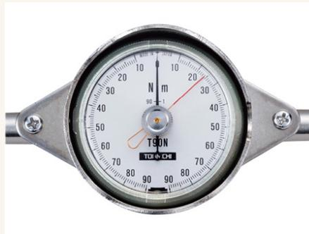
Die T-S Modelle sind standardmäßig mit Schleppzeiger zum nachträglichen Ablesen des Spitzenwertes ausgestattet. Dank der beweglichen Skale kann der Zeiger zunächst auf den gewünschten Drehmomentwert eingestellt werden, sodass er beim Abschluss des Anziehvorgangs auf '0' weist.
