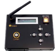
Abb.: R-CM mit M-FH Funkmodul
