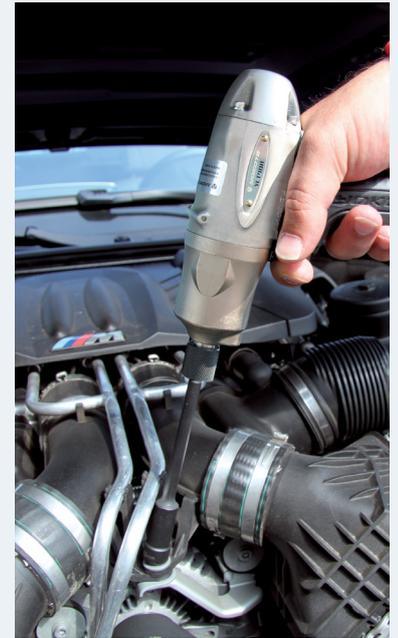
schnell erreicht. Ein harter Schraubvorgang benötigt nur 1-2 Sekunden. Und es gelangen keine Drehmoment-Reaktionen ins Handgelenk des Bedieners.
